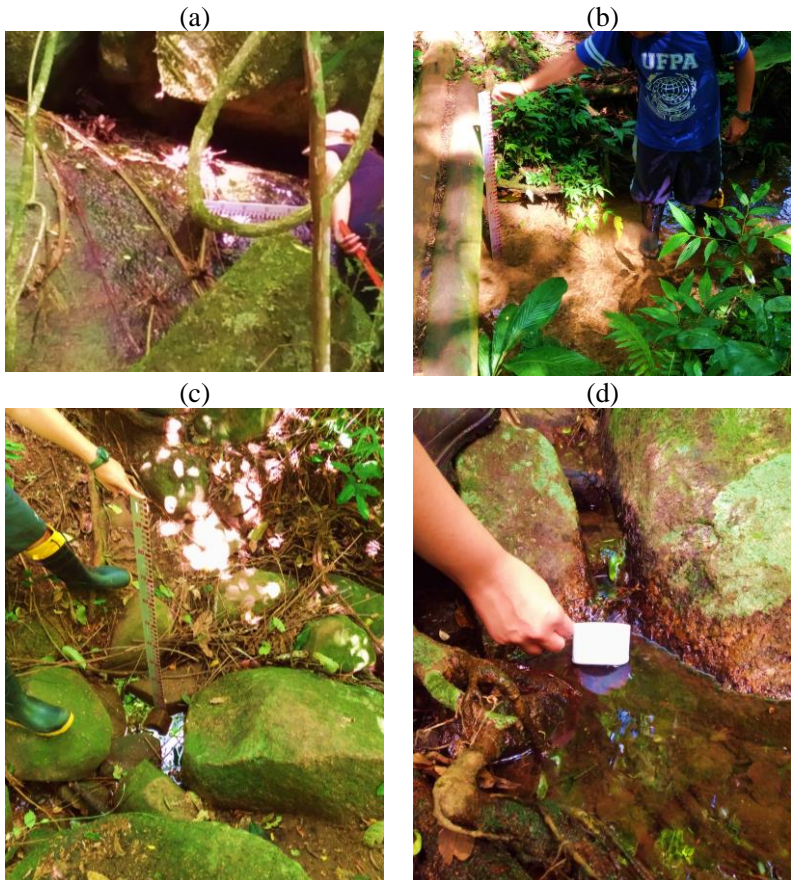
Figura 12 – a) Água vertendo sobre a rocha; b) Seção com fluxo laminar; c) Típica seção do trajeto, onde a água verte em meio as pedras e; d) medição de vazão utilizando o método volumétrico.
