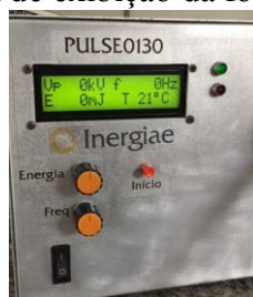
Figura 10. Foto do painel de exibição da fonte de alta tensão pulsada.
