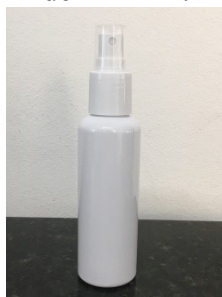
Figura 14. Foto do borrifador utilizado no procedimento de aspersão das NPs-ZnO nos filmes de PELBD.
