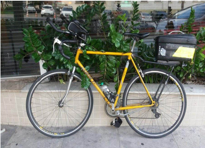
Figura 3 - Bicicleta do Kayo (speed com marchas), com bagageiro traseiro e caixa térmica acoplada com o auxílio de cordas. Carga: massas congeladas
