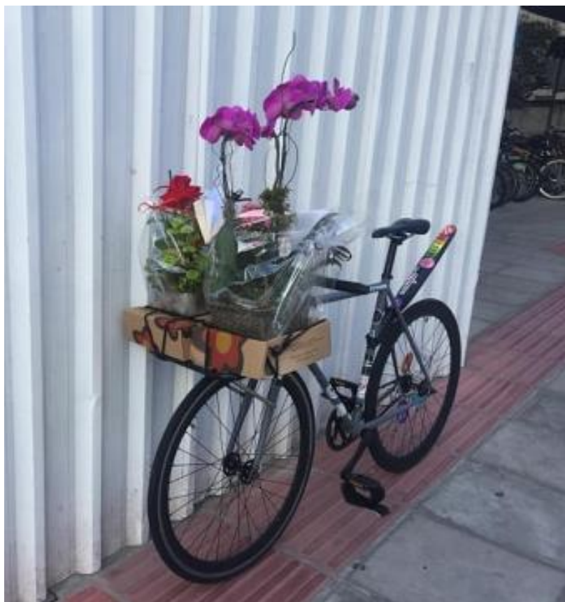
Figura 4 - Bicicleta da Brenda (fixa) com bagageiro frontal, extensores e caixa de transporte. Carga: arranjos de flores de diferentes tamanhos
