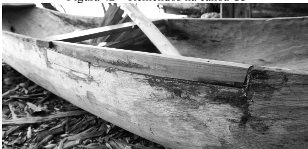
Figura 42 – Remendos na canoa C3
