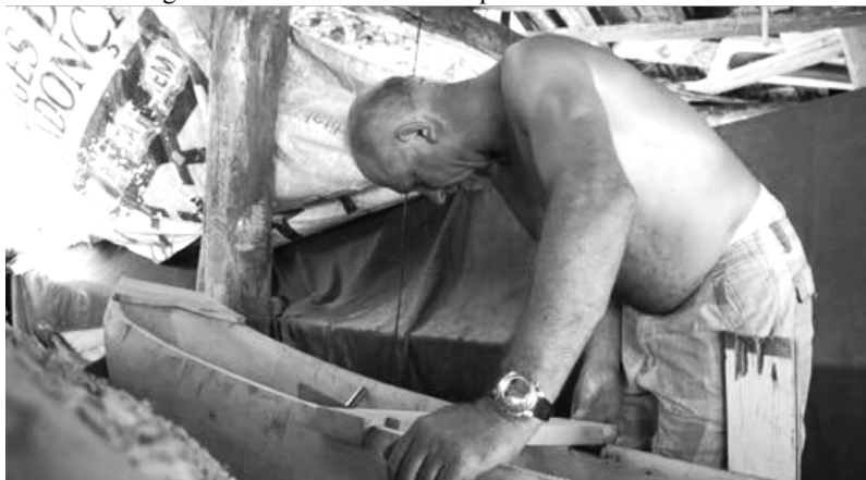
Figura 38 – Dico coloca tábua para banco na canoa C1
