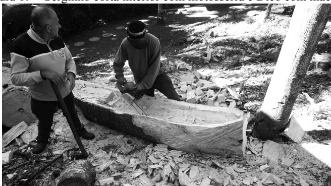
Figura 19 – Serginho corta interior com motosserra e Dico com machado
