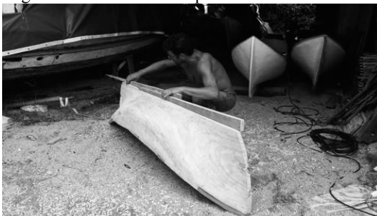
Figura 35 – Dudu coloca quilha com duas madeiras
