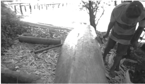
Figura 45 – Zico passa óleo de transformador na canoa C3
