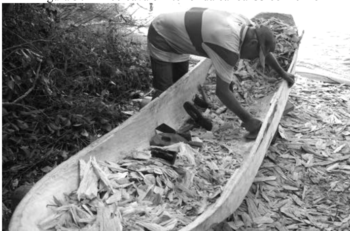
Figura 30 – Zico cava o interior da canoa C3 com enxó
