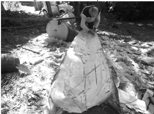
Figura 18 – Dico marca a lápis as bordas
