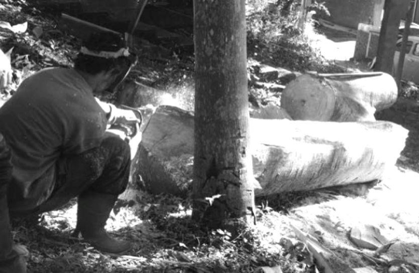
Figura 17 – Serginho corta as laterais da proa com motosserra
