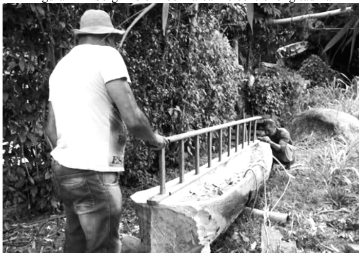
Figura 22 – Serginho e Dico marcam o centro longitudinal
