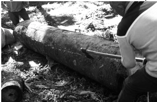
Figura 16 – Dico marca com o machado o tampão
