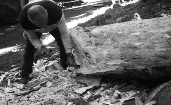
Figura 20 – Dico abre buraco com formão na popa da canoa
