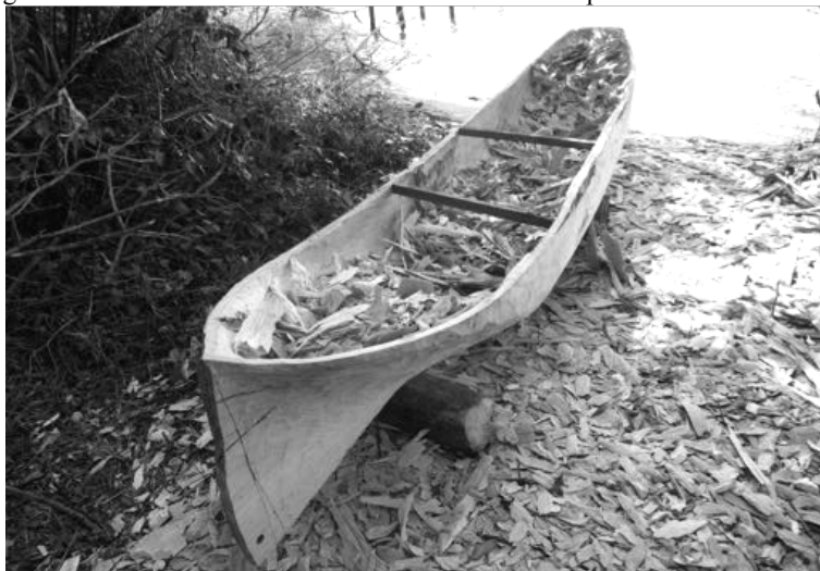
Figura 29 – Canoa C3 com madeiras no seu interior impedindo seu fechamento
