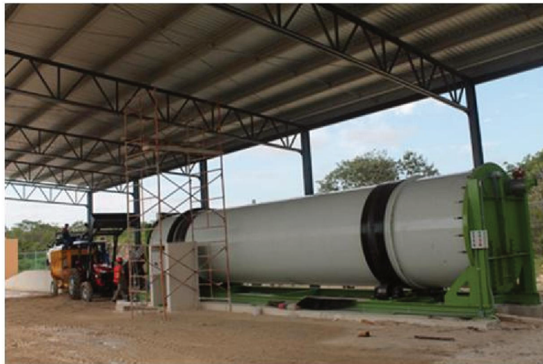
Figura 2.8- Cilindro rotativo utilizado para compostagem. Fonte: www.xactsystemscomposting.com
