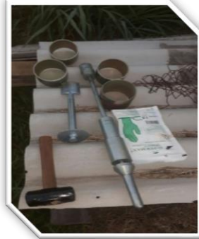
Figura 9 – Coleta de solo para a determinação da densidade do solo da vala.
