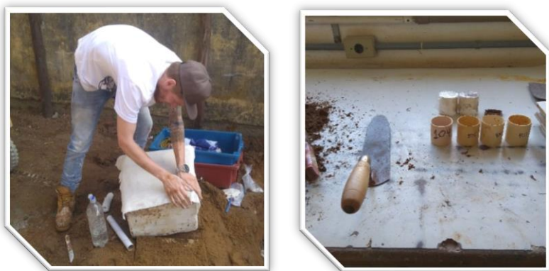
Figura 10 – Coleta e moldagem do solo para o ensaio do Papel-filtro.
