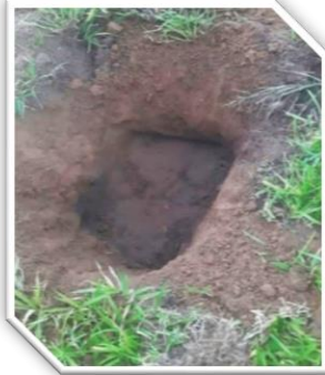
Figura 9 – Coleta de solo para a determinação da densidade do solo da vala.
