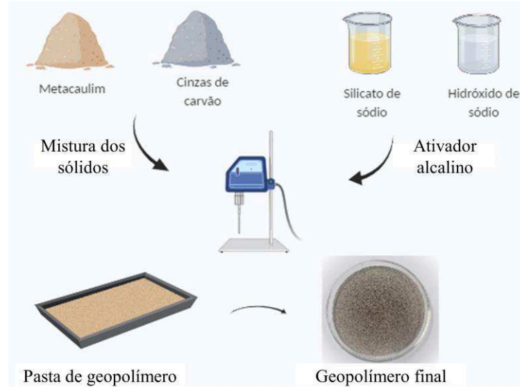
Figura 6 - Esquema representativo da síntese do geopolímero.
