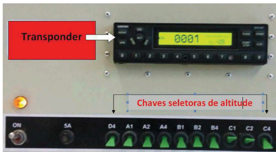
Figura 37 – Cadeia reduzida de um transponder e chaves seletoras de altitude.
