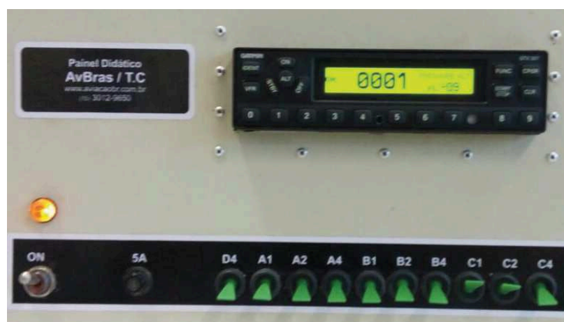
Figura 40 – Seleção do posicionamento de chaves para uma altitude qualquer.
