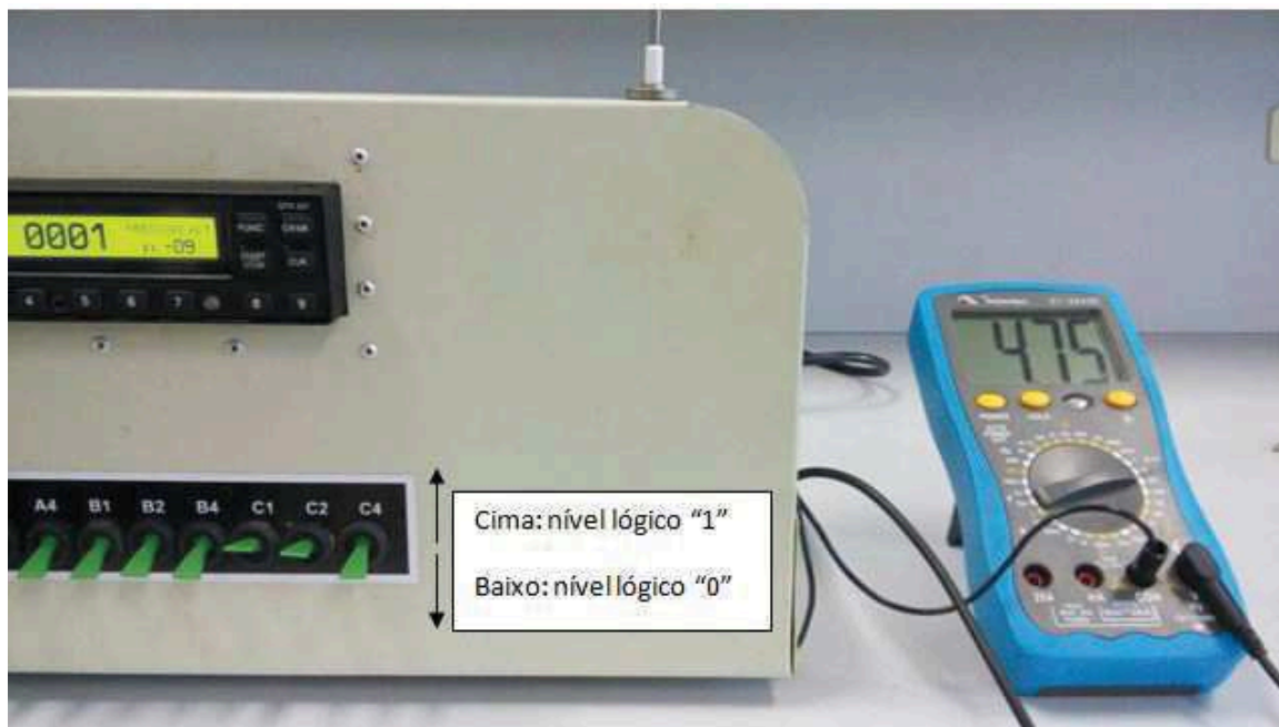
Figura 38 – Medição da tensão relacionada à chave seletora C4 em nível lógico "0".
