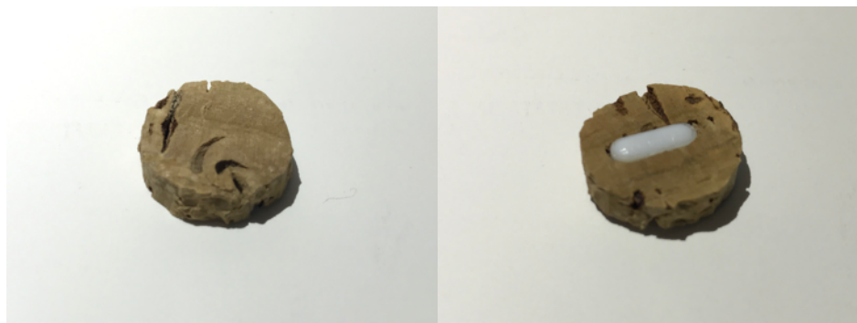
Figura 40 - Aparato para RSE sendo apresentado em uma foto superior e inferior da fase extratora (na parte inferior a barra de agitação magnética é inserida).
