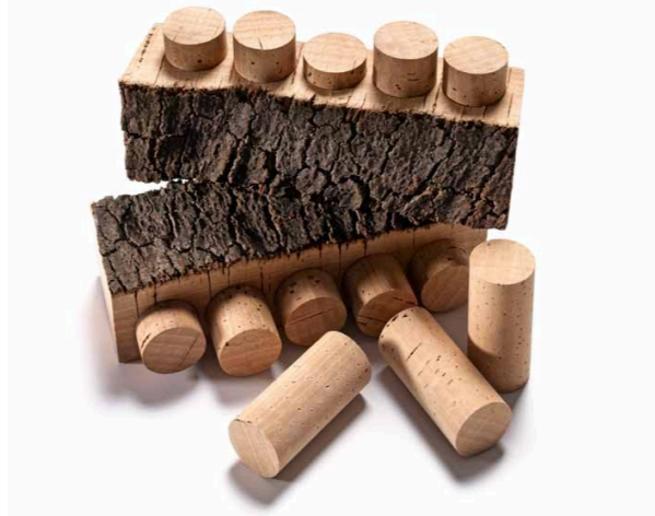
Figura 8 - Demonstração da forma com que rolhas de cortiça são cortadas da casca.
