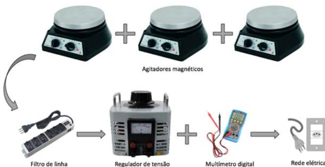
Figura 31 - Esquema do acoplamento dos agitadores ao regulador de tensão.
