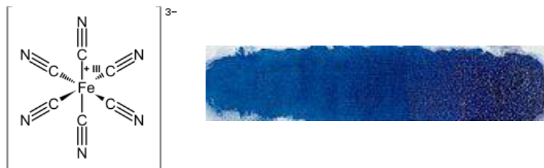
Figura 7 - Estrutura do azul da Prússia e sua coloração típica
