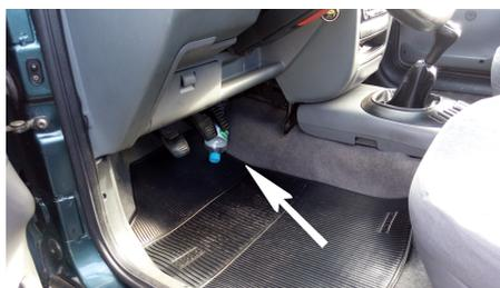
Figura 15: Garrafa de água posicionada sob um dos pedais, comprometendo a eficiência do mesmo.
