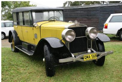
Figura 3: O automóvel à vapor Doble Model E11, de 1924.
