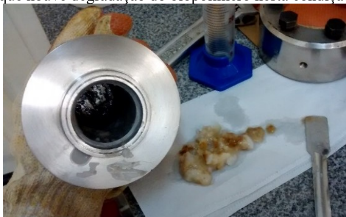
Figura A2 – Hidrogel produzido na temperatura de gelatinização de 120°C. A imagem mostra que houve degradação do biopolímero nesta condição.
