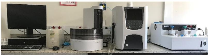
Para a determinação do Fósforo Total utilizou-se o KIT HACH de determinação de Fósforo. Nesse procedimento adiciona-se 1mL do reagente 1 e 1 mL do reagente 2 e aguarda-se o tempo de reação. A leitura foi realizada no espectrofotômetro Hach® DB 2800 com comprimento de onda 660 nm.
