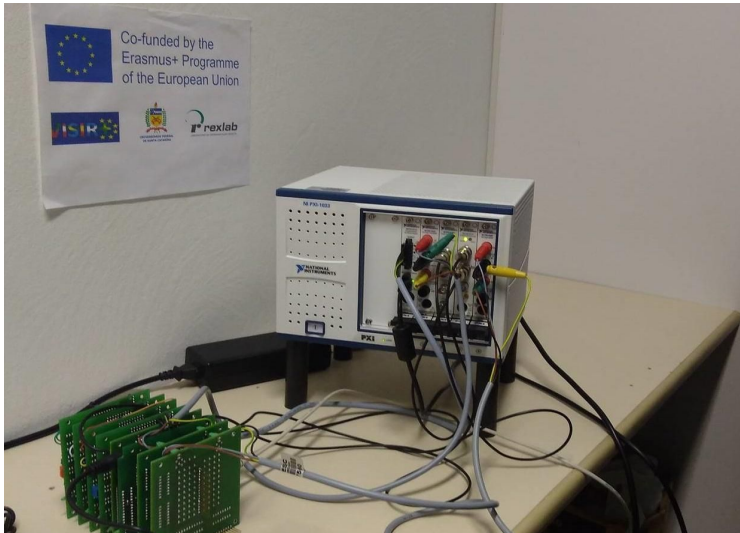
Figura 10 - Módulo VISIR instalado no RExLab
