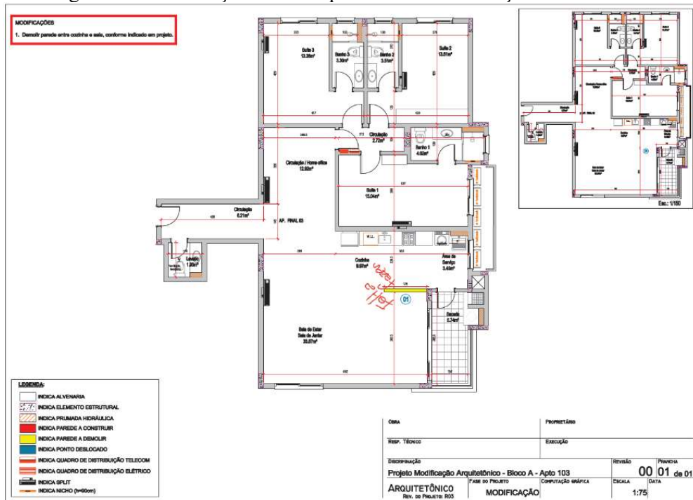
Figura 27 – Verificação de incompatibilidade de execução de alvenarias.
