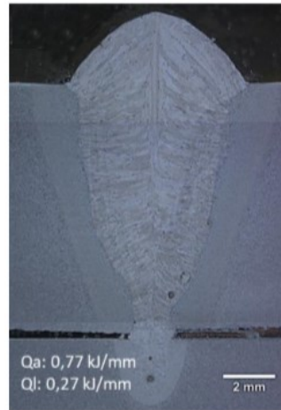
Figura 12 - Variação do formato de cordão HLAW típico, devido à utilização de elevada potência do arco com o GMAW de arco enterrado. (Fonte: [61])
