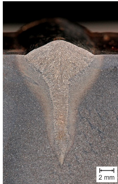
Figura 37 – Macrografia da seção transversal do cordão de solda HLAW com 10 kW de potência Laser e 1 m/min de velocidade de soldagem, alcançando 14,8 mm de profundidade de penetração. (Fonte: Autor)
