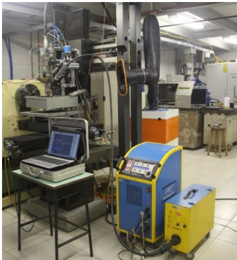
Figura 30 – Foto (esquerda) e esquemático (direita) da bancada de trabalho utilizada para procedimentos GMAW, LBW e HLAW. (Fonte: Autor)
