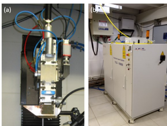
Figura 25 - (a) Cabeçote de soldagem YW52 fabricado pela empresa Precitec. (b) Fonte Laser de fibra YLS 10000 fabricada pela empresa IPG Photonics®. (Fonte: Arquivo do Laboratório
