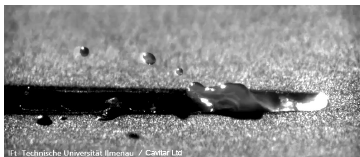
Figura 8 – Imagem obtida por filmagem em alta velocidade do processo de soldagem LBW, evidenciando a formação de respingos durante o procedimento. (Fonte: [23])
