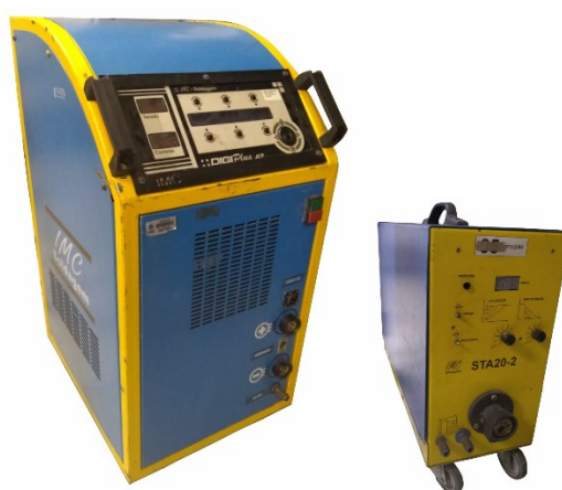
Figura 27 – Fonte de soldagem DIGIPlus A7 multiprocessos e tracionador de arame STA20-2, ambos fabricados pela empresa IMC Soldagem. (Fonte: Autor)
