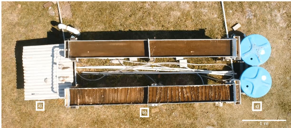
Figura 2. Vista superior do Sistema Algal Turf Scrubber. O ponto a) é localizada a casa de bombas e sistema de distribuição de água; b) são as rampas onde se fixam os substratos; c) caixas de água para regime fechado. O sentido do fluxo ocorre na direção de a) para c).
