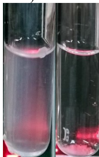
Figura 6 - Adsorção com esferas de alginato: amostra homogênea (esquerda) e amostra heterogênea que mostra sólidos depositados no fundo do tubo (direita).
