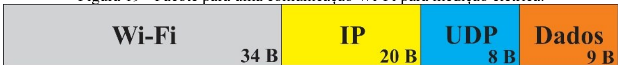
Figura 19 - Pacote para uma comunicação Wi-Fi para medição elétrica.
