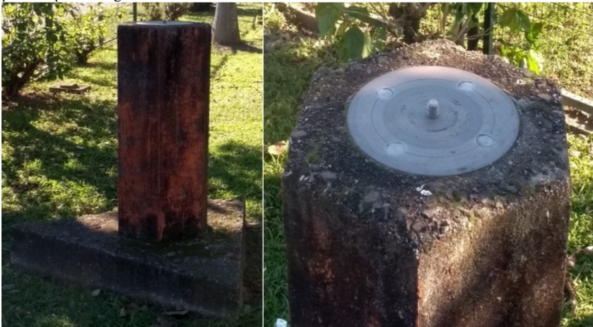
Figura 18 – Marco do IBGE situado no interior da Universidade do Extremo Sul Catarinense – Unesc, ponto o qual estão georreferenciadas as cartas cadastrais de Nova Veneza-SC.
