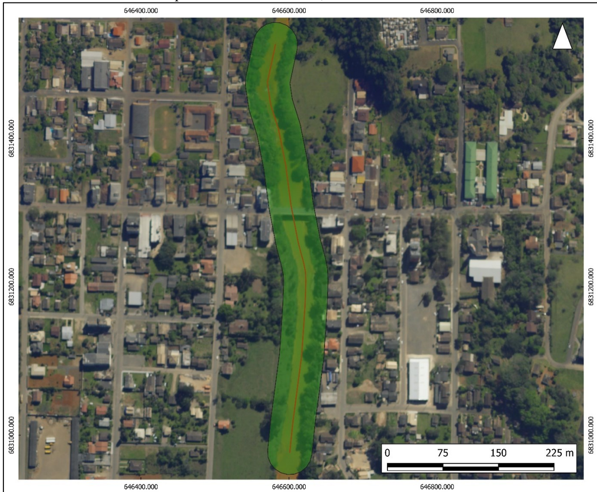
Figura 26 – Exemplo de delimitação de APP a partir do software SIG, utilizando a ferramenta buffer, com 30 metros de distância a partir da linha vetorizada, no meio do rio.
