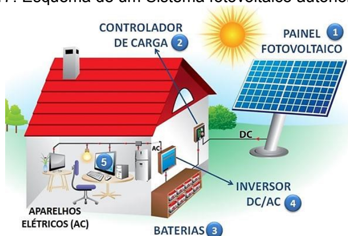
Figura 17: Esquema de um Sistema fotovoltaico autônomo
