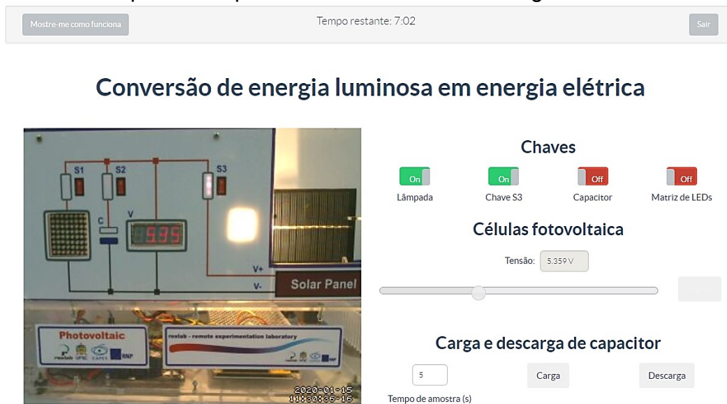
Figura 20: Acesso por desktop ao LR – Conversão de Energia Luminosa em Elétrica
