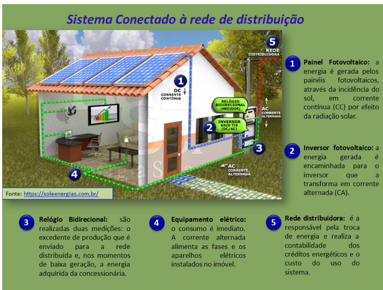
Figura 7: Esquema de um sistema conectado à rede de distribuição
