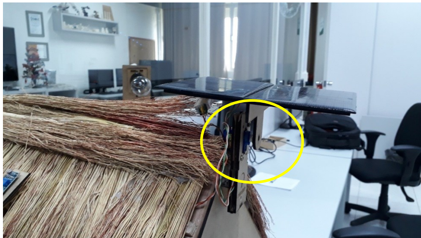
Figura 39: Montagem do servo motor
