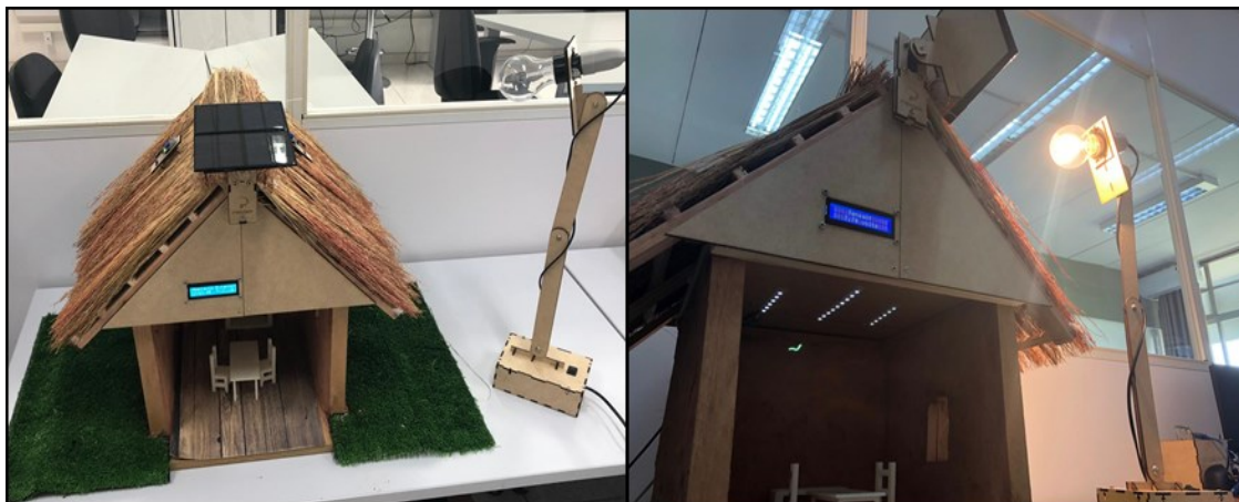
Figura 32: Instalação dos componentes eletrônicos da edificação
