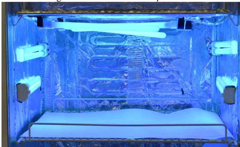
A delimitação deste espaço resultou de alguns testes preliminares, a partir da determinação da irradiância e posição da amostra. A irradiância emitida pelas lâmpadas foi determinada em todos os quadrantes da base da câmara, e a várias distâncias da lâmpada.
