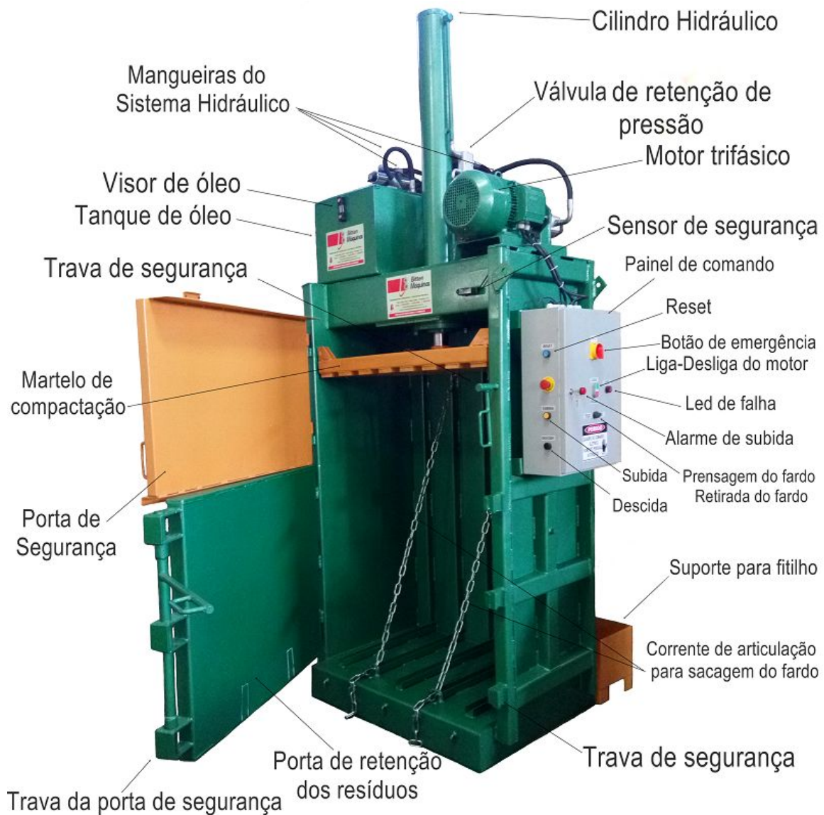
Figura III - Prensa enfardadeira de materiais
