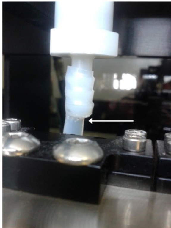
Figura 18 - Rompimento de um dos modelos de aneurisma em silicone junto à conexão com sistema de carga (seta branca).
