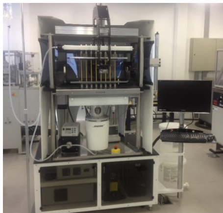
Figura 9 - Máquina de ensaios TA ElectroForce® 9400 Multiaxial Peripheral System Instrument e computador de controle no Laboratório de Engenharia Biomédica da Universidade Federal de Santa Catarina.
