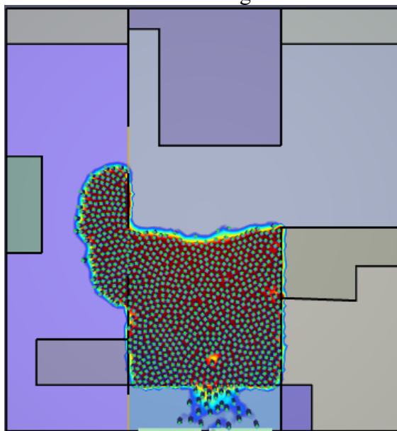
Figura 56: Gráfico de densidade de deslocamento, gerado pelo Pathfinder, para o cenário 17 com saídas dimensionadas 25% acima das dimensões exigidas nas normas, demonstrando a aglomeração da multidão causada pelo bloqueio gerado na passagem que fica anterior as saídas de emergência.
