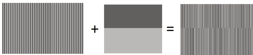
Figura 16 – Combinação no SLM de grade de difração e variação de fase do modo HG_{0,1} produzindo a máscara com diferença de fase \pi entre o nível superior e o inferior.
