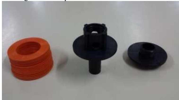
Figura 16 - Crepina em sua forma desencaixada.
