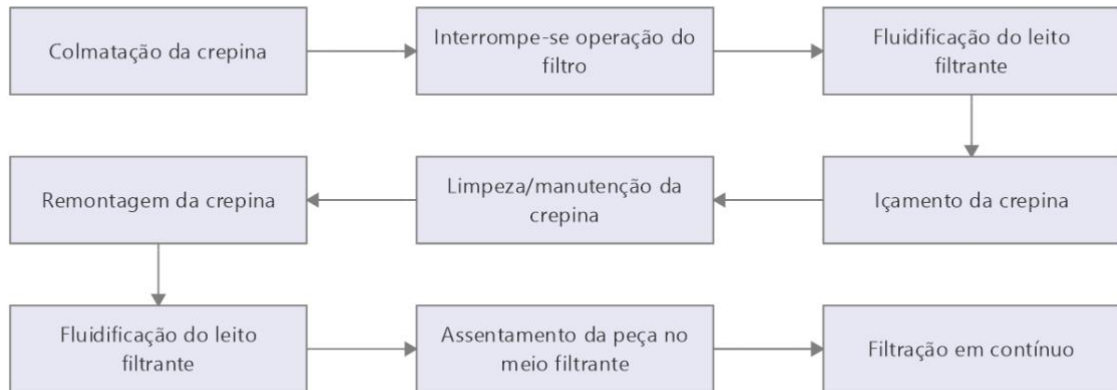
Figura 21 - Procedimentos de limpeza do dispositivo de coleta do filtrado.
