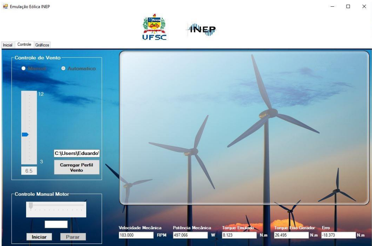
Figura 34. Aba de controle da aplicação .NET operando em modo automático de velocidade de vento.
