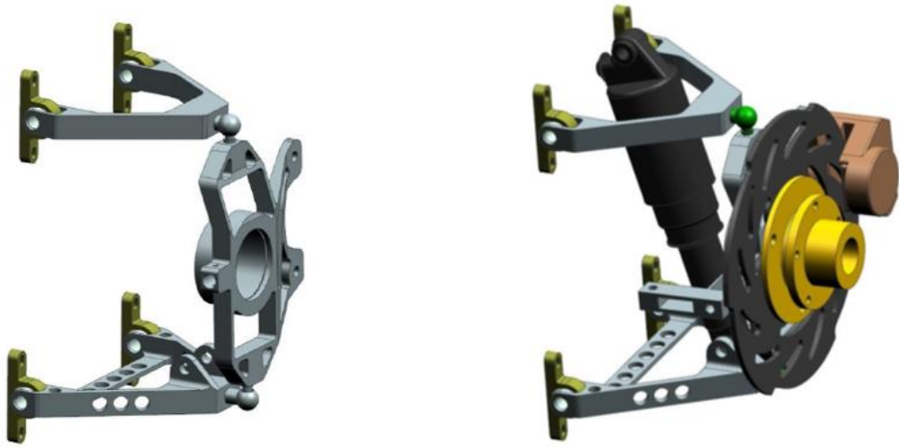
Figura 12 – Sistema de Suspensão Duplo A para Protótipos Ultra Eficientes
