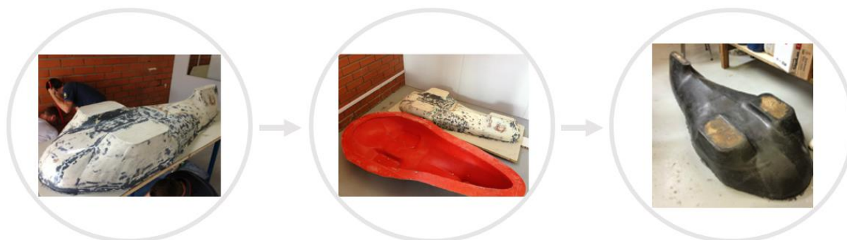
Figura 7 – Método de Laminação à Vácuo em Protótipo Ultra Eficiente
