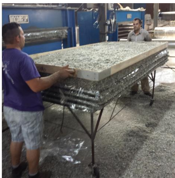
Figura 14 – Gabarito preenchido com polietileno e alumínio recuperados de embalagens longa vida cartonadas.
