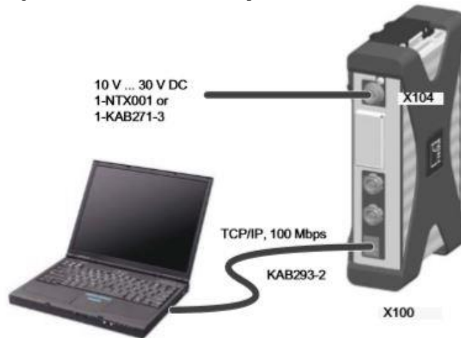
Figura 14 - Conexão entre o computador e o módulo MX440B
