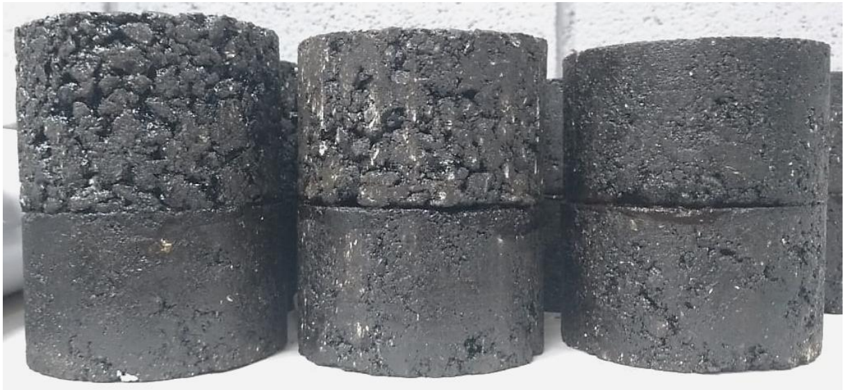
Figura 5.5 - Conjuntos de Amostras Após a Aplicação da Emulsão em suas Interfaces: Esquerda (BBDr/BBSG), Centro (BBTM/BBSG) e Direita (BBSG/BBSG).
