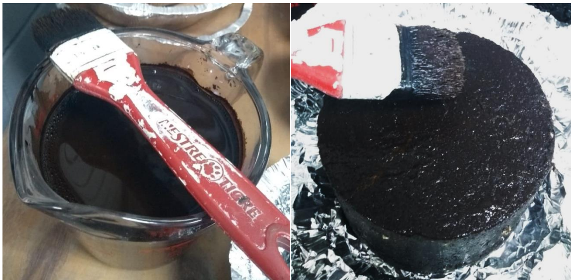
Figura 5.4 - Aplicação da Emulsão na Interface dos Conjuntos de Amostras.
