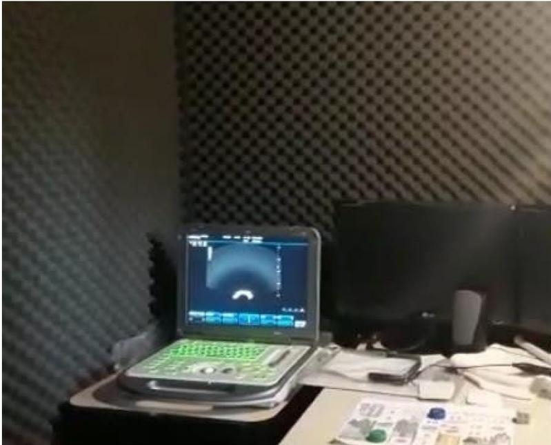
**Figura 1:** Cabine acústica, local de gravação para avaliação e *biofeedback* ultrassonográfico com os seguintes equipamentos: microfone unidirecional; transdutor micro-convexo acoplado a um aparelho de ultrassom portátil (*Mindray M5*); computador; sincronizador; caixa de som; estabilizador de cabeça (*Articulate Instruments Ltda*).
