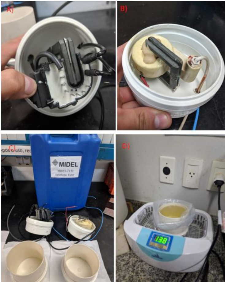
Figura 11 – Processo de Isolamento com Óleo Mineral
