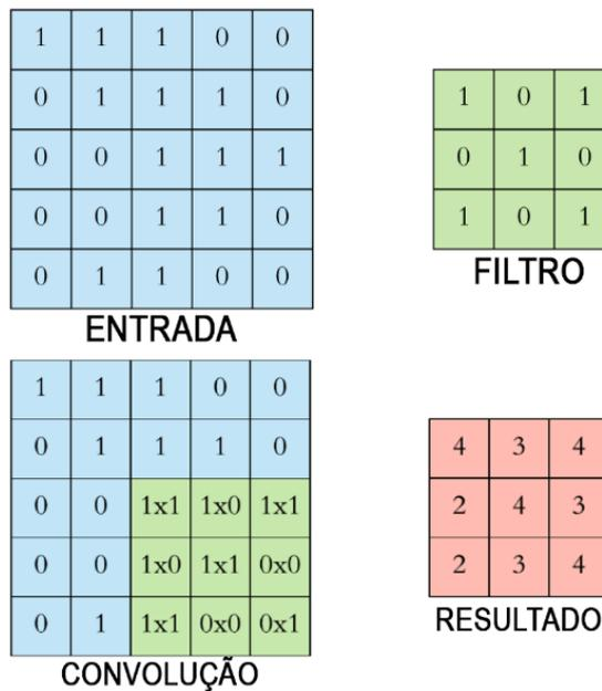
Figura 20 - Exemplo de Convolução (adaptado a partir de KARKARE, 2019).
