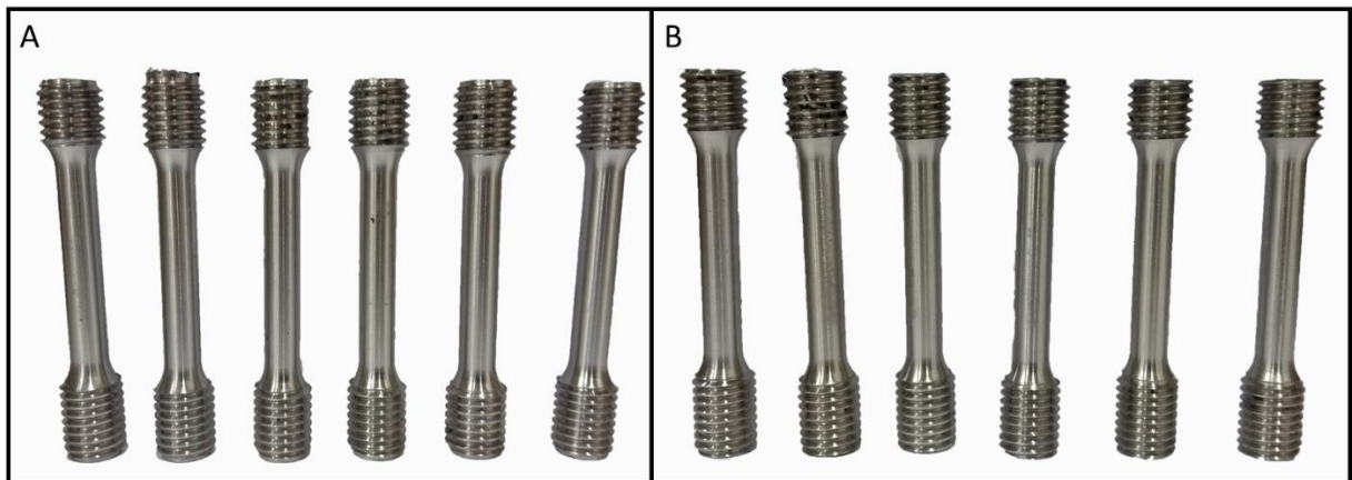
Figura 46: Corpos de prova usinados A) fabricados na orientação XY e B) fabricados na orientação ZX.
