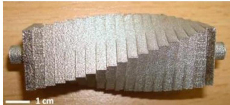
Figura 22: Corpo de prova para medição de rugosidade para diferentes orientações de fabricação.
