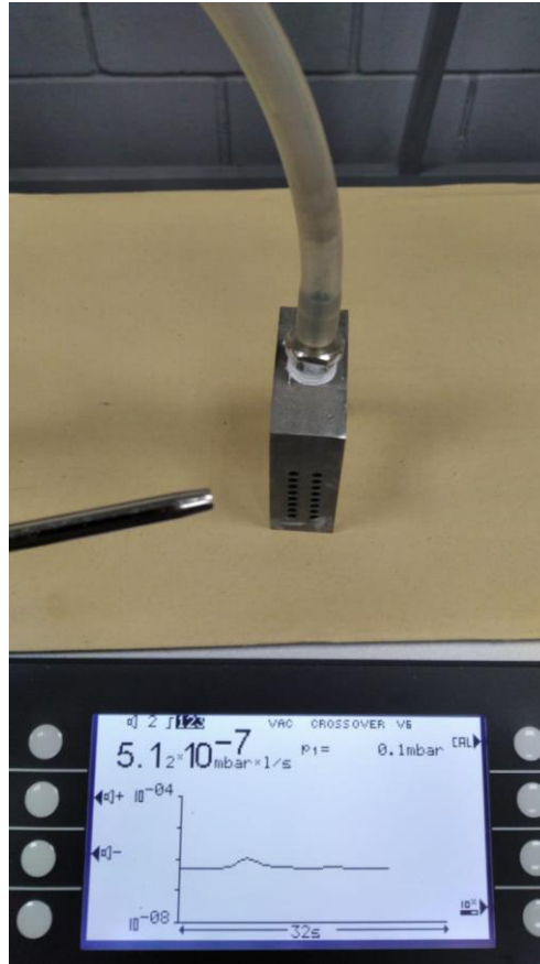
Figura 50: Ensaio de detecção de vazamento.
