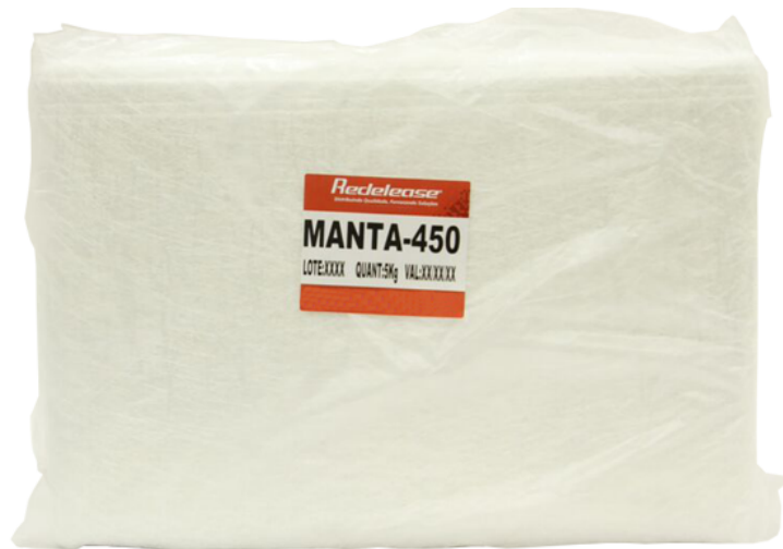
Figura 14 – Manta M450 utilizada na laminação dos amostras do Tipo II.
