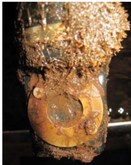
Figura 6 – Sensor óptico após ser acometido pelo processo de bioincrustação.
