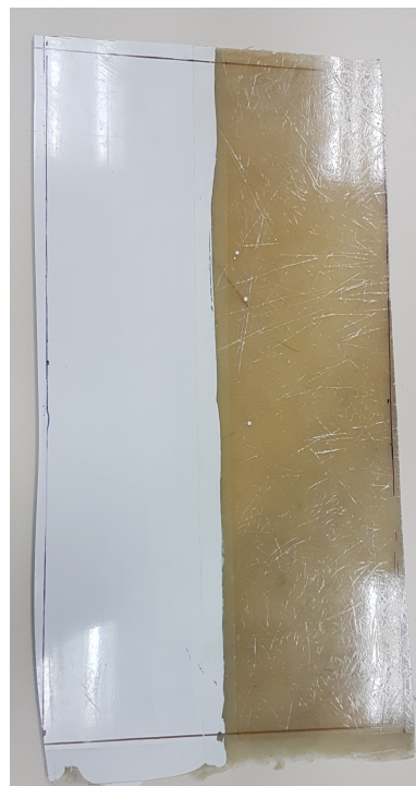
Figura 11 – Placa de compósito reforçado com fibra de vidro obtida após processo de laminação.
