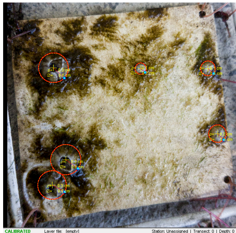
Figura 28 – Exemplo de medição dos diâmetros das cracas no photoQuad .
