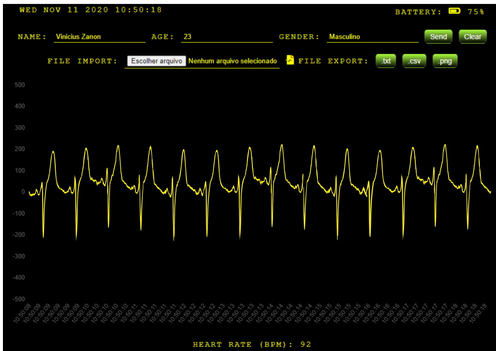
Figura 30 – Interface de Saída - Aplicação Web do Monitor ECG.
