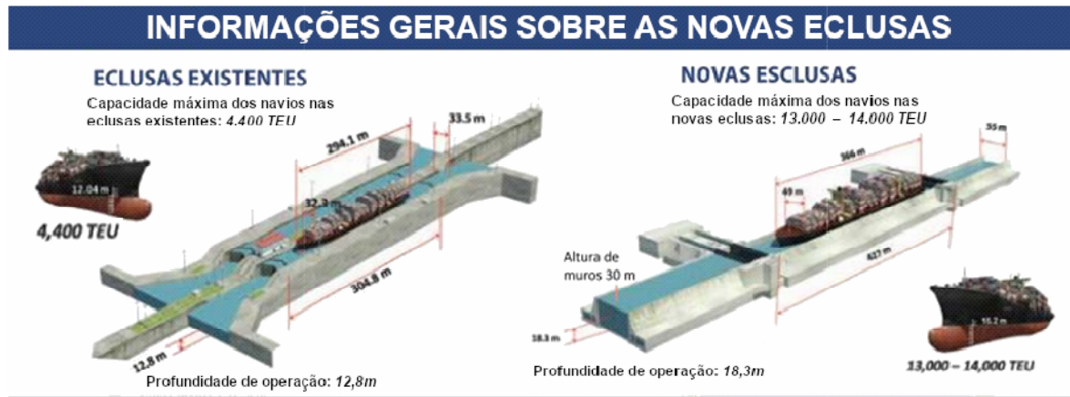
Figura 4 – Capacidade Canal do Panamá
