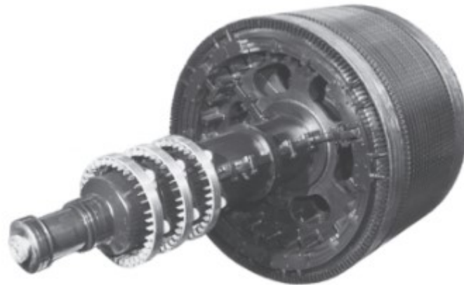
Figura 3 – Estrutura típica de um rotor do tipo bobinado.
