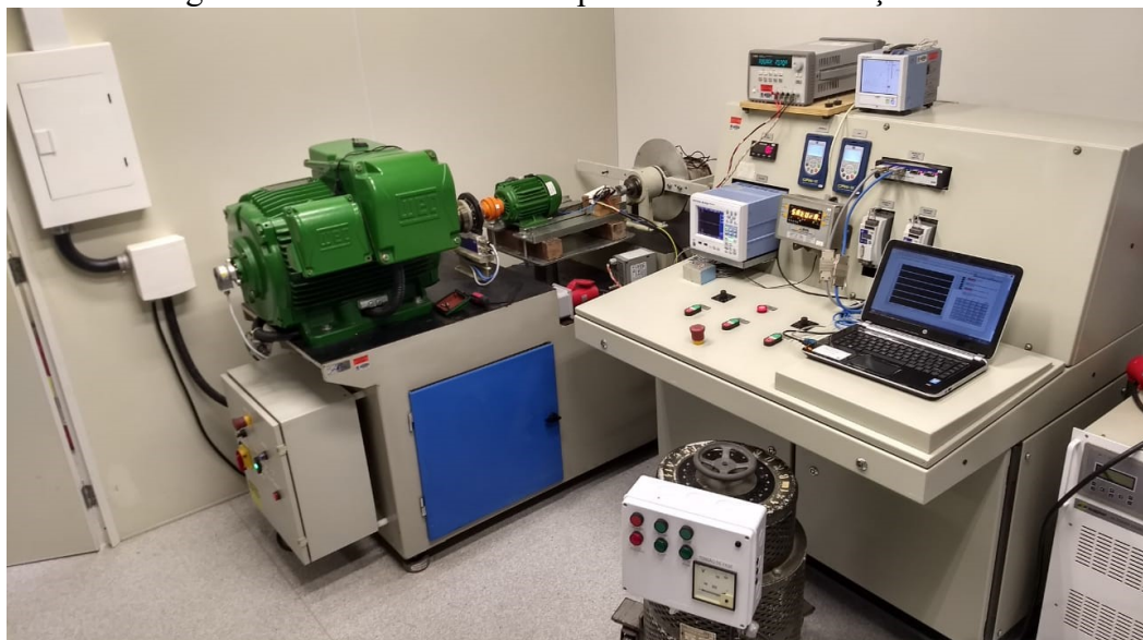
Figura 10 - Bancada de testes para motores de indução.
