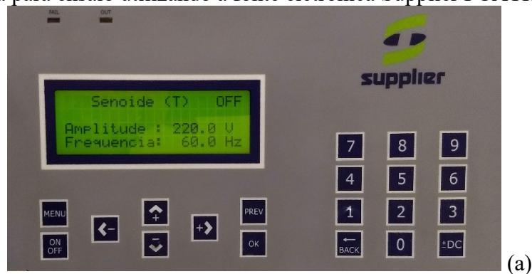
Figura 45 – Configurações de (a) Tensão e frequência, (b) Tipo de rampa e (c) Tempo de rampa para ensaio utilizando a fonte eletrônica Supplier FCATH3000.
