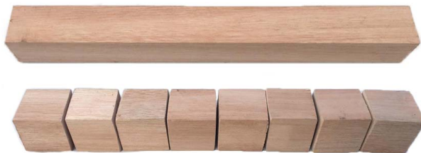
Figura 74 – Processo de fabricação dos cubos
