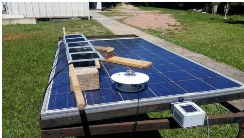
Figura 12: Processo de calibração outdoor da célula de referência. Fonte: Rosso (2019).
