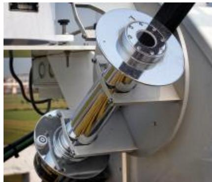
Figura 11: Representação do pirheliômetro. Fonte: Kipp e Zonen (2016).
