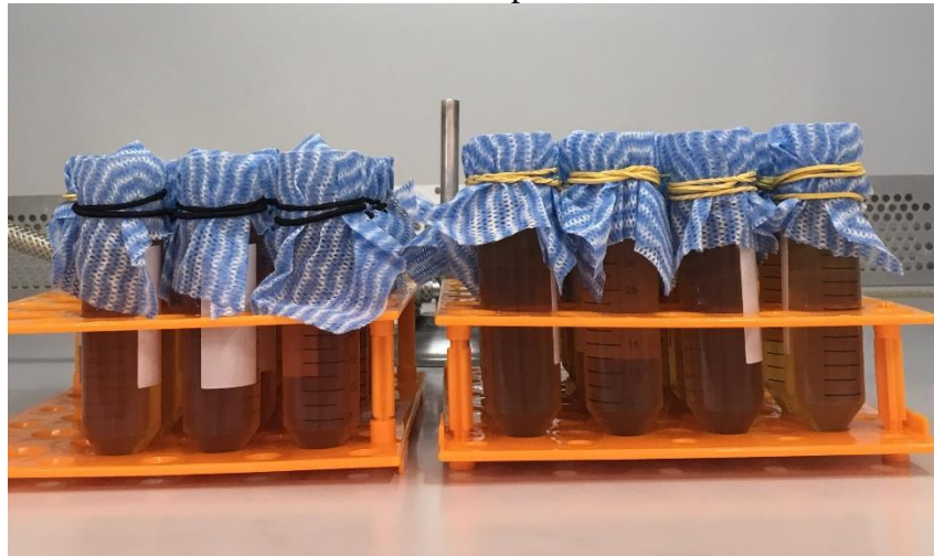
Figura 6 – Sistema de fermentação usado. Falcons contendo o meio de fermentação, cobertos com tecido poroso
