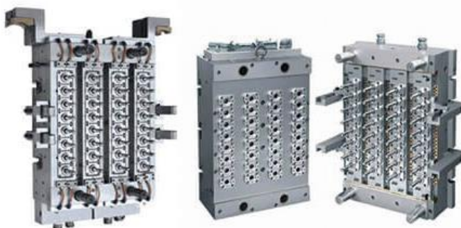
Figura 6 - Molde de pré-formas da injetora
