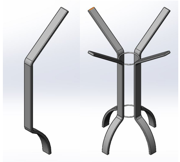
Figura 57. Haste separada (esquerda) e o conjunto das quatro hastes (direita) em vista isométrica. Fonte: O autor (2020).
