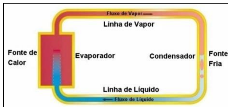
Figura 18: Esquema de funcionamento de um termossifão em circuito
