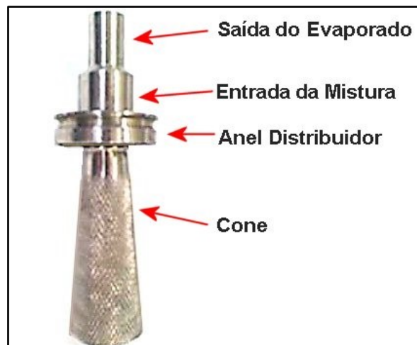
Figura 30: Sistema de Distribuição da Alimentação (SDA)
