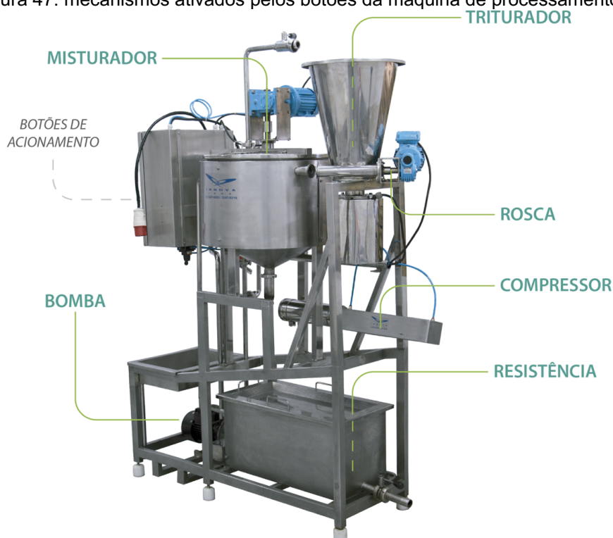
Figura 47: mecanismos ativados pelos botões da máquina de processamento.
