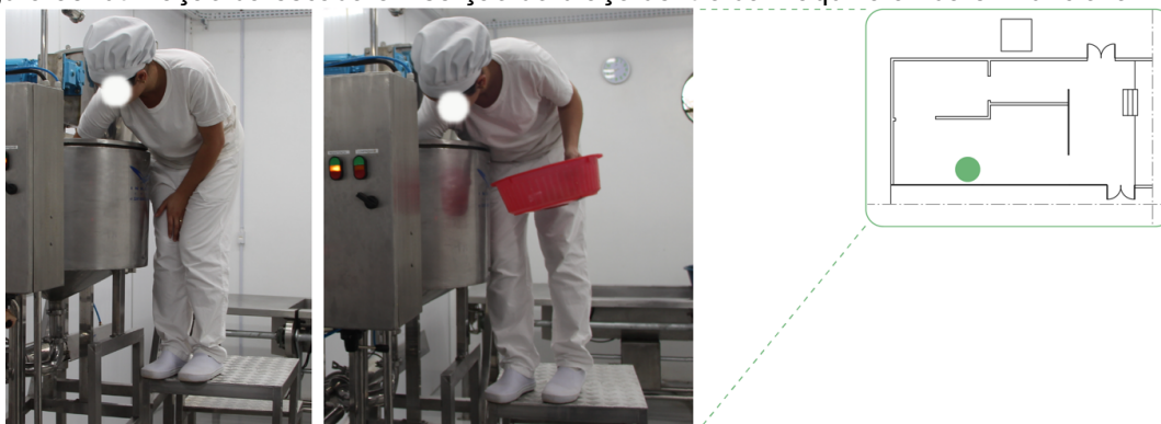
Figura 53: utilização da escada e inserção do braço dentro da máquina ainda em funcionamento.
