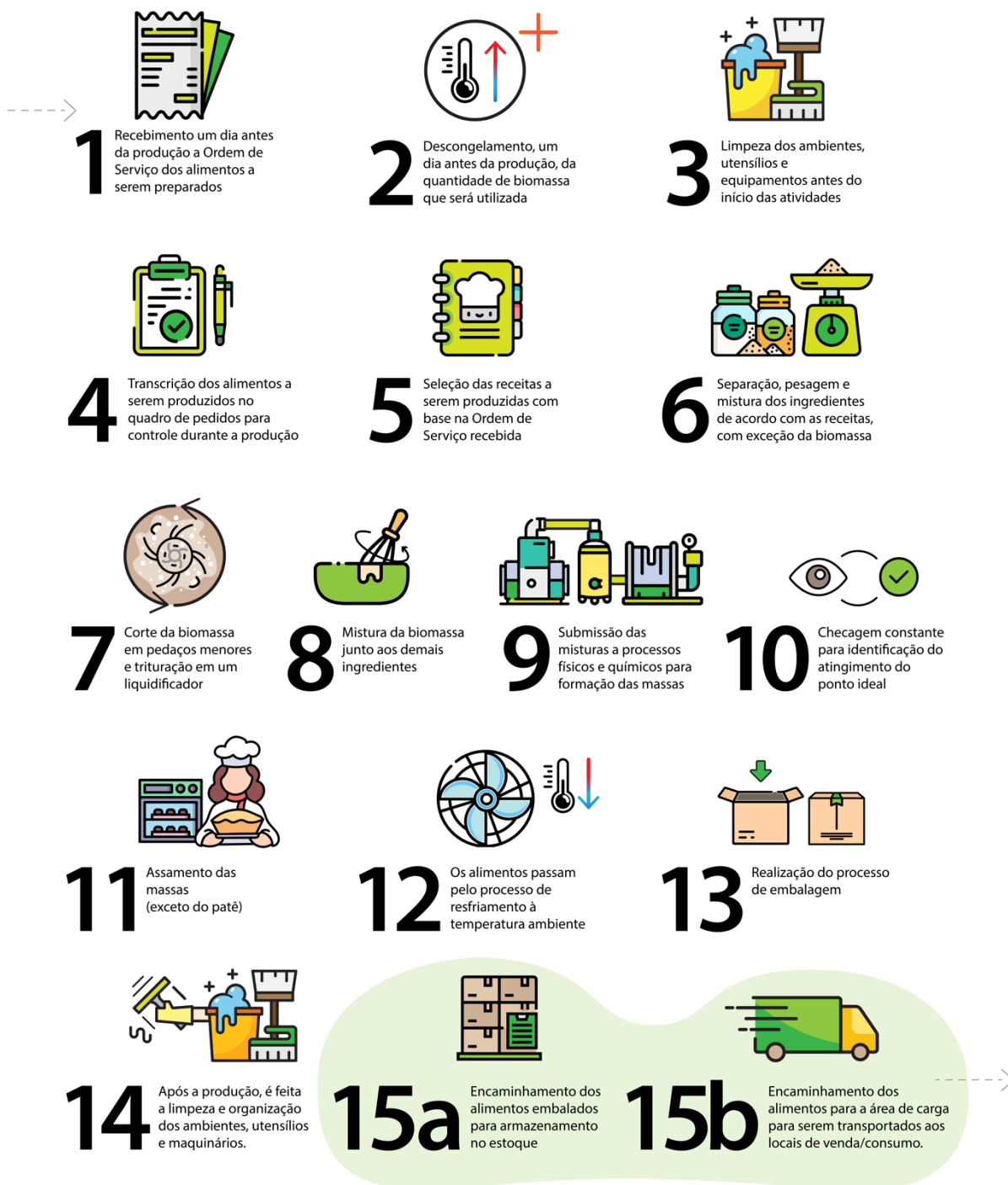
Figura 77: representação esquemática da produção de panificados.
