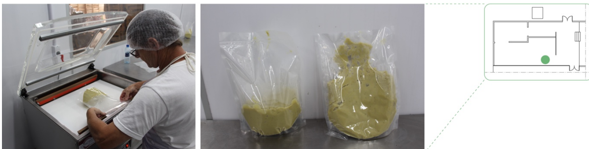
Figura 45: selagem e embalagens que apresentaram falha no processo.
