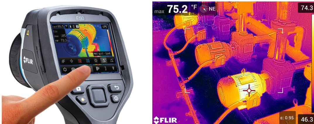
Figura 116: exemplos de câmera termográfica infravermelha (esquerda) e termograma (direita).
