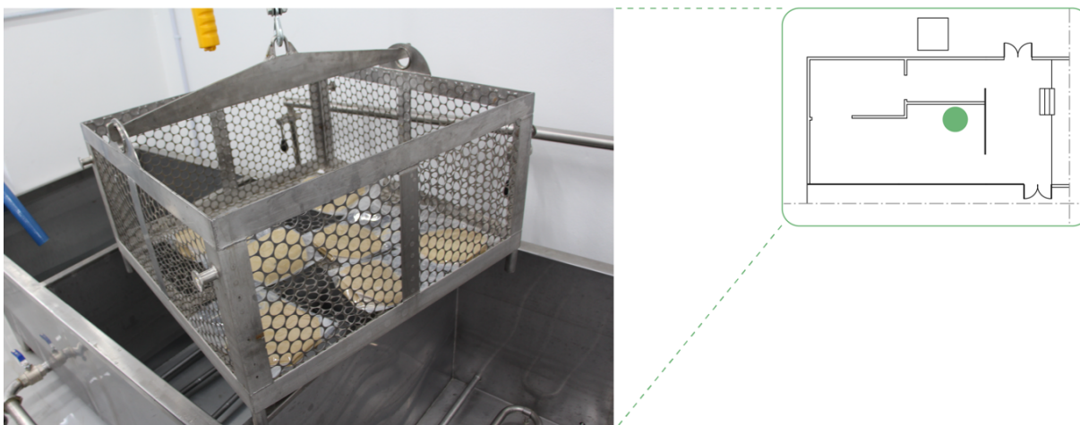
Figura 46: gaiola e tanques utilizados no processo de pasteurização.
