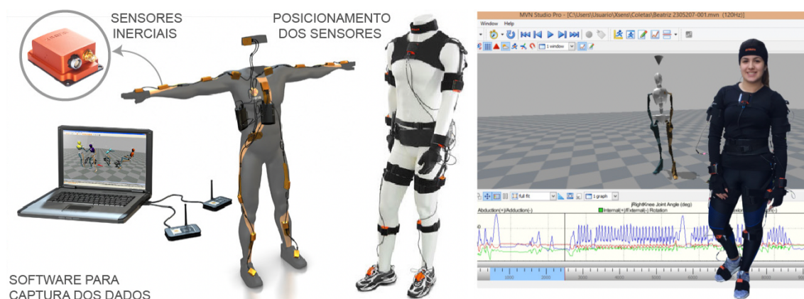
Figura 119: sensores do MVN Link Biomech (à esquerda) e representação virtual (direita).
