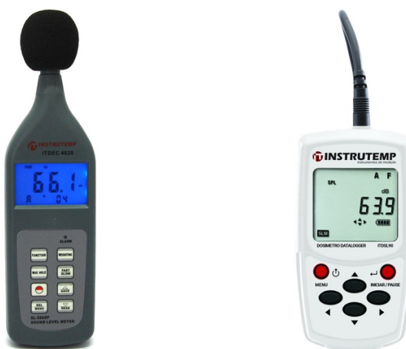
Figura 115: exemplos de Medidor de Nível de Pressão Sonora (esquerda) e dosímetro (direita).
