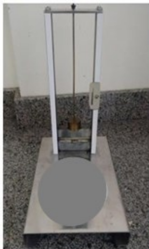
Figura 1 - Prensa utilizada para lesão por contusão.
