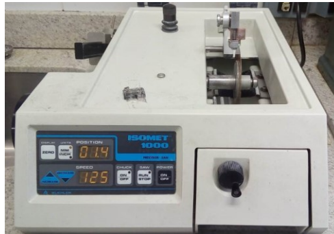
Figura 5 - Cortadora metalográfica de precisão (Isomet 1000, BuehlerLtd, Lake Bluff, IL, EUA)
