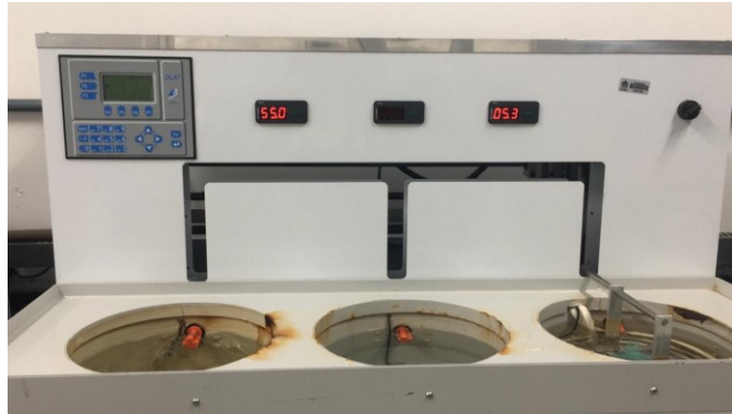
Figura 8 - Cicladora térmica de três temperaturas (Thermocycle, Biopid®, São Carlos, SP, Brasil).
