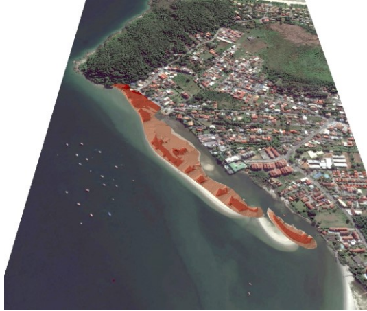
Figura 34 - Pontal arenoso em 3D a partir do processo de interpolação - Ponta das Canas
