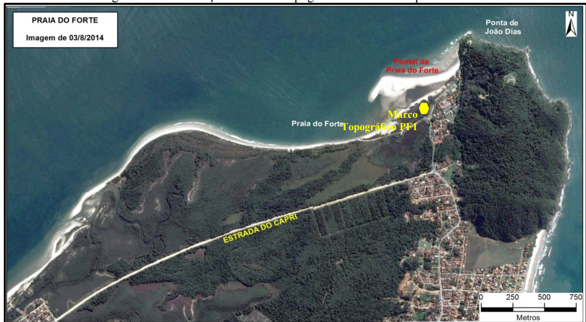
Figura 26 - Localização do marco topográfico instalado na praia do Forte
