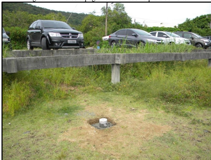
Figura 27 - Marco topográfico instalado na praia do Forte.
