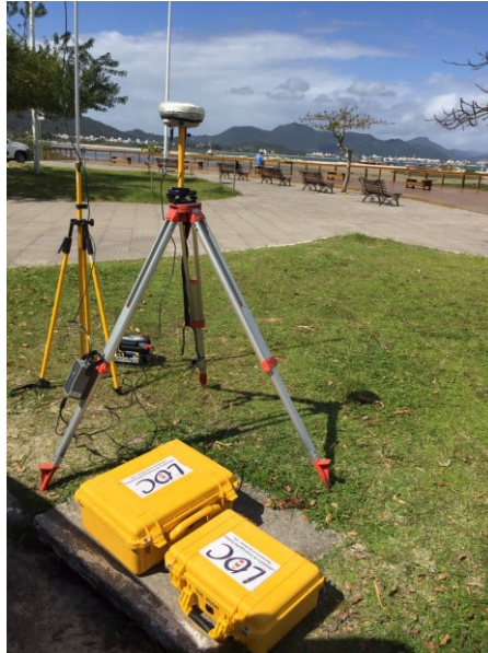
Figura 24 - Base do Receptor GNSS instalado no marco topográfico na Ponta das Canas
