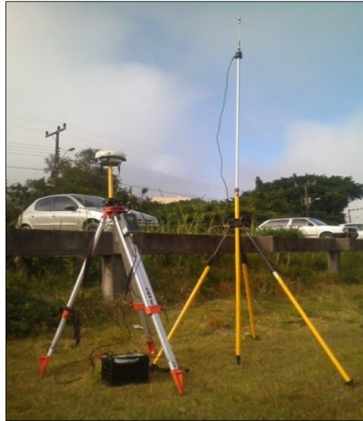
Figura 28 - Base do Receptor GNSS instalado no marco topográfico.
