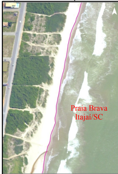
Figura 22 - Exemplo de delimitação da linha de costa a partir do indicador linha seca-molhada.
